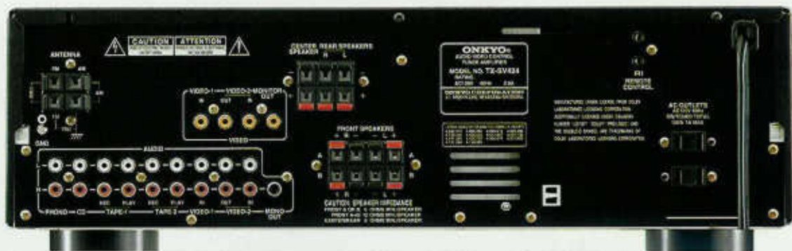
Der Anschluß des TX-SV424 ist denkbar einfach, dank Lautsprecheranschlüssen mit Federklammern und zahlreichen Cinchbuchsen für Audio- und Videoquellen.
